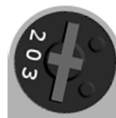
Prawe skrajne położenie potencjometru
