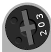
Lewe skrajne położenie potencjometru
